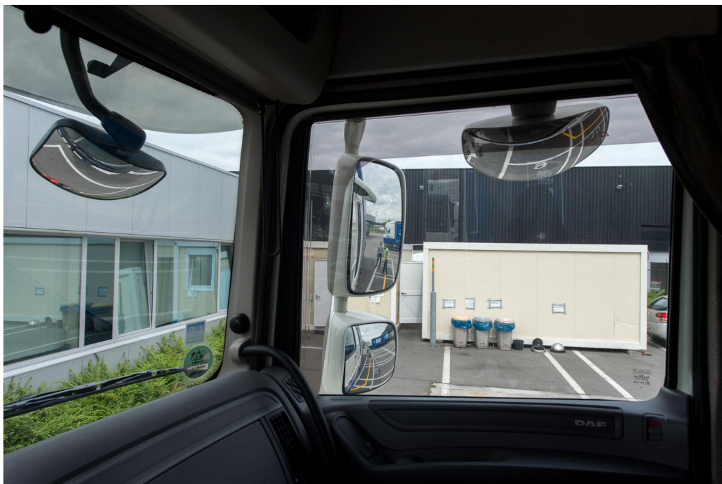
Afbeelding 1.3. Een spiegelconfiguratie aan de rechtervoorzijde van een vrachtauto. De dodehoekspiegel werd verplicht in 2003 en de vooruitkijkspiegel (in dit rapport voorzichtspegel genoemd) in 2007 (Buck, 2006).
